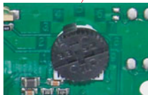
Potentiometer für Feldeinstellungen
