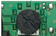
Potentiomètre pour réglages du champ
