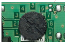
Potentiomètre pour réglages du champ
