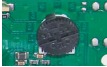
Alan ayarları için potansiyometre
